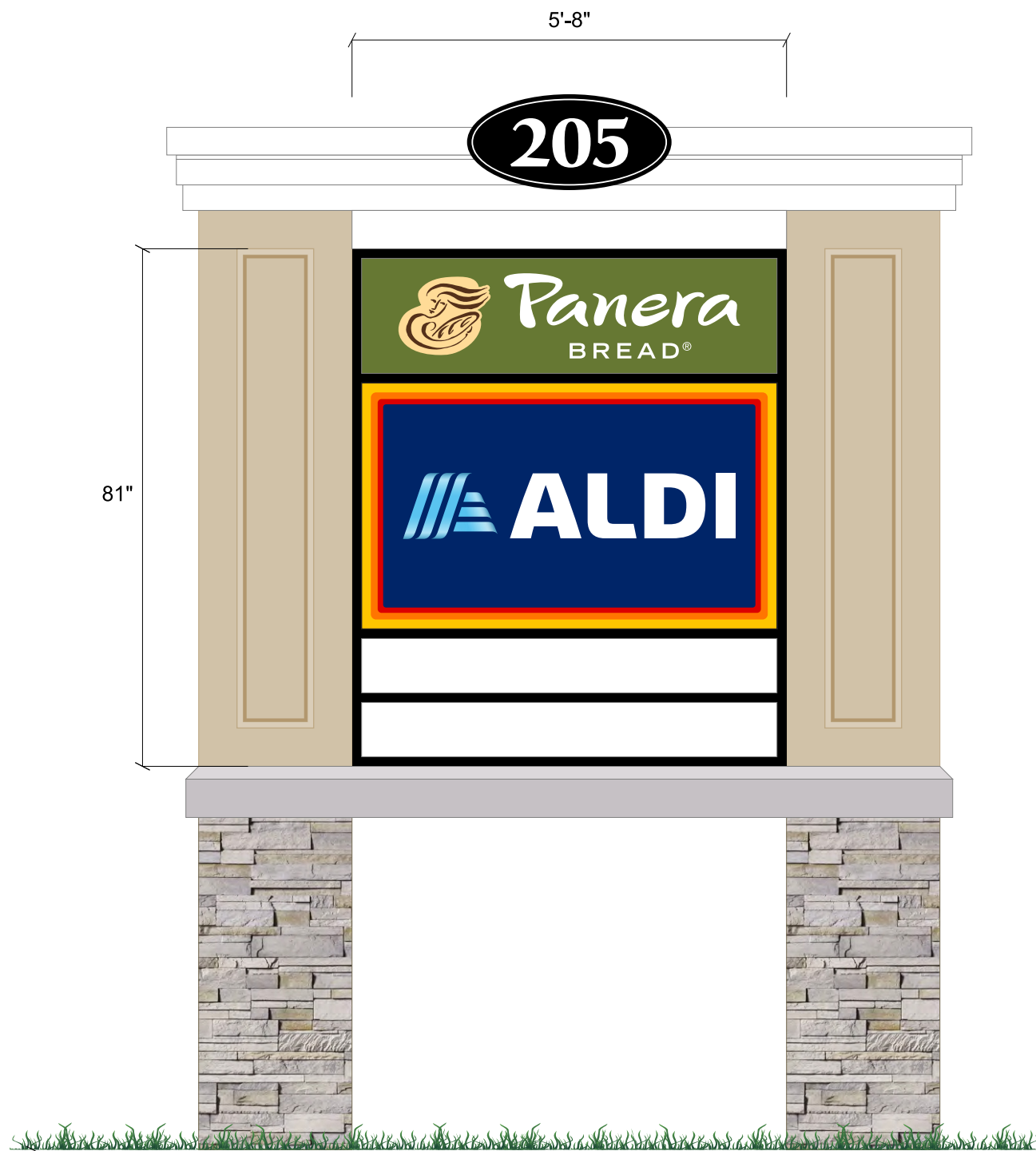
Double Face Pylon Scale: 1/2" = 1'-0"
